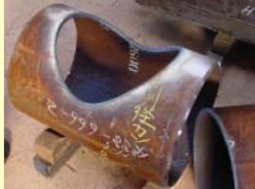
6軸制御 座標変換はユーザアプリケーション プラズマ/ガス切断
